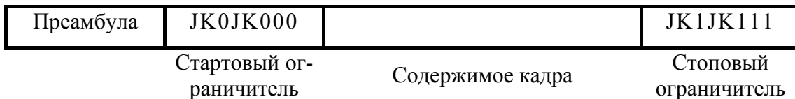
Рис. 10.3. Способы выделения начала и конца кадра при синхронной передаче
