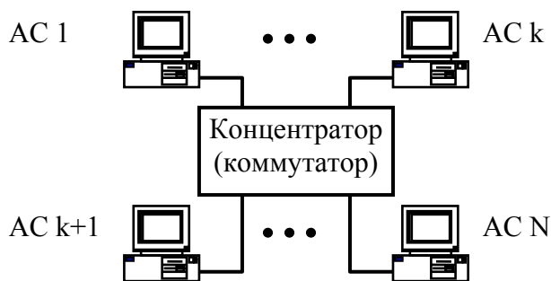
Рис.15.2. Сеть Ethernet / IEEE 802.3 с топологией «звезда»
